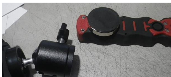
ホルダーの磁石を取り外して SLB12W にねじ込んで使用
